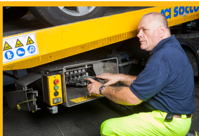
AGGANCIATA Posizionato il carro di fronte alla vettura in panne, Pier Luigi sgancia il verricello e procede a issarla sul camion: l'operazione va svolta con attenzione e rapidità per evitare di danneggiare il veicolo e per limitare gli intralci alla circolazione.
